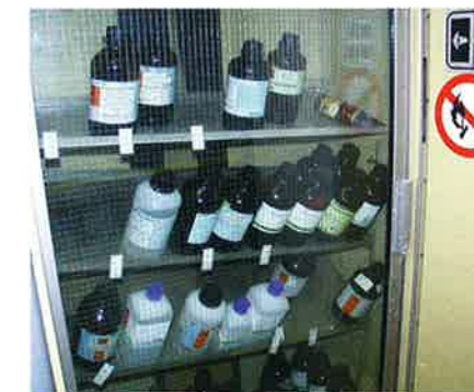
De zuurkast met ingezakte schapdragers.
