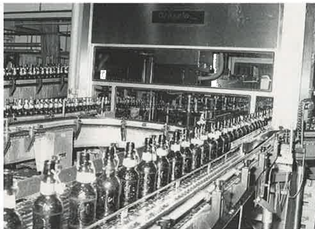
De inmiddels geopende flessen gaan links de 'snuffelaar' in en komen er - ná goedkeuring - rechts weer uit, op weg naar de spoelmachine.
