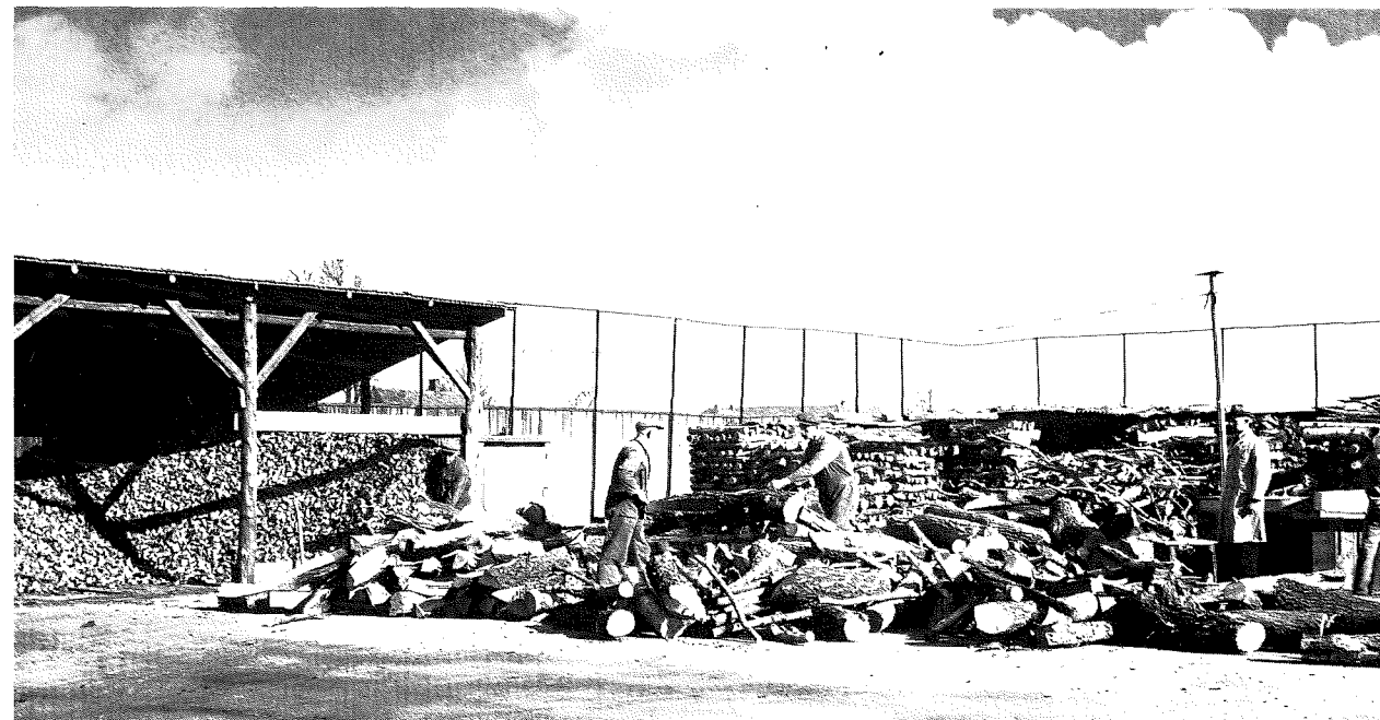
De grote hoeveelheid houtblokjes op het bij het terrein van de brouwerij in Enschede behorende tennisveld werden gebruikt als 'brandstof' voor de vrachtwagens via een op die wagens gemonteerde hout-vergasser. Ook enkele personenauto's reden op houtgas, waarbij de vergasser op een aanhangwagentje was geplaatst.
