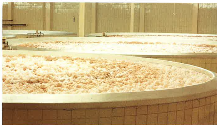
DE HOOFDGISTING VINDT PLAATS IN DEZE GROTE KUIPEN.
